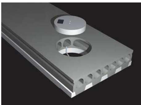
Afb. 5.9 Zorg er voor dat de isolatie onder een kruipluik goed aansluit op de isolatie van de vloer. Hiervoor bestaat een goede oplossing: een losse prefab isolatiedeksel dat in een speciale ophangbeugel geplaatst wordt. Kruipluik en isolatiedeksel zijn niet aan elkaar verbonden. Het hier getoonde vloerelement is voorzien van een door de fabrikant geboord kruipgat. Gebruik een goed luchtdicht kruipluik met een soepele
