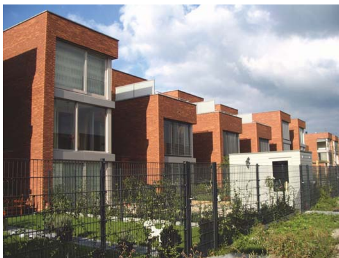
Afb. 4.7 Bij deze z.g. 'strokenverkaveling' in de wijk Roomburg in Leiden is gekozen voor een standaard gaashekwerk als erfscheiding in combinatie met de snelgroeiende klimop. Deze erfscheiding is geplaatst om te voorkomen dat er een wildgroei van schuttingen ontstaat en om te bereiken dat er toch voldoende privacy is en tegelijkertijd de buurt een groen uiterlijk krijgt. Bewoners zijn via de erfpachtovereenkomst verplicht om deze erfscheidingen in stand te houden. Er is een boeteclausule om het verwijderen van de erfscheiding tegen te gaan. (Betrokken partijen: planontwikkeling: Gemeente Leiden, architect: Geurst & Schulze Architecten, ontwikkelaar: du Prie bouw & ontwikkeling; realisatie 2004)
